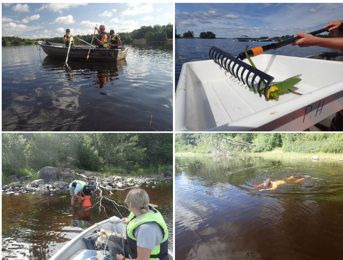
Figur 3. Längs varje transekt gjordes krattning efter makrofyter och musslor var femte meter, då även vattendjupet och förekommande substrattyp noterades (överst). I de grundare områdena kunde även vattenkikare och snorkling användas som komplement längs transekterna (nederst).
